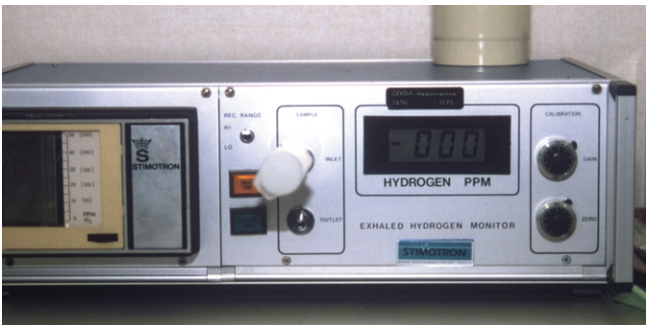
Abb. 2: Gerät zur Bestimmung von Wasserstoff in der Ausatemluft.
